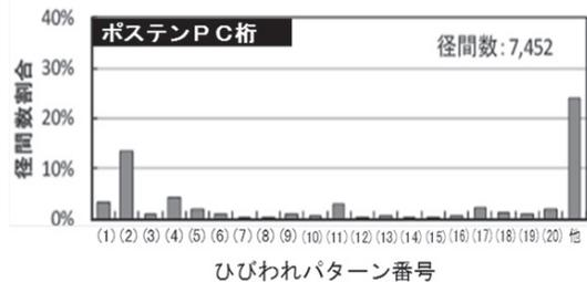
図-2 点検結果(ひびわれパターン毎)
