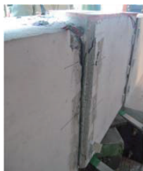
写真-1 水平ずれ変位(供試体 No. 2)
