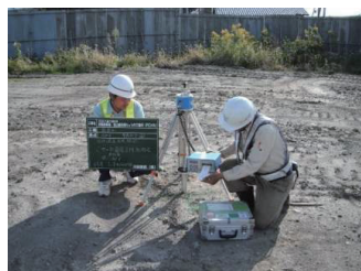
写真-7 地盤耐力測定状況
