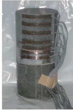
図-5 鋼板補強供試体
