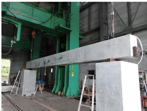
写真-1 PC実験桁の全景
