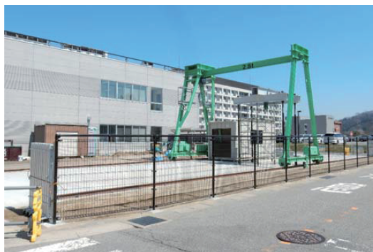
写真-5 大型構造物載荷試験装置(全景)
