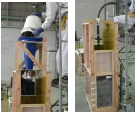
写真-1 打込みおよび締固め状況
