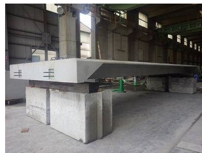
写真-4.3 床版部材外観
