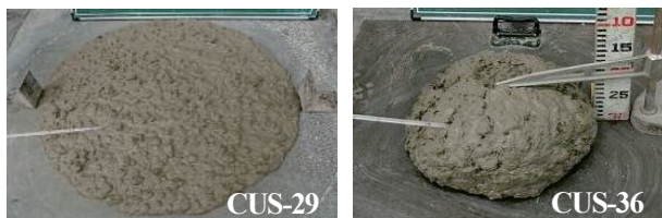
写真-3.1 フレッシュコンクリートの試験状況
