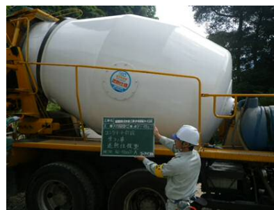
写真-4 遮熱仕様の生コン車
