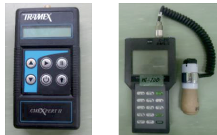
1) 静電容量式 2) 電気抵抗式 水分計
