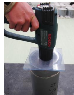
写真-4 熱風を用いた乾燥の実施状況
