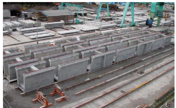
写真-1 セグメント仮置き状況
