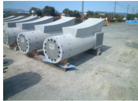
写真-4 丸柱②の製作
