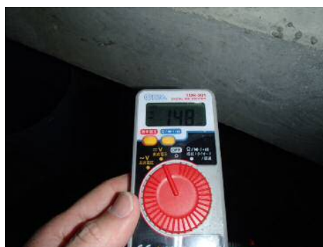
写真-5 電位モニタリング状況
