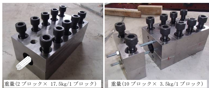
(1) 二つ割り一体型 (2) 二つ割り5分割型 写真-1 中間定着装置
