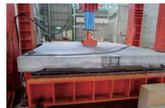
写真-3 床版耐力試験状況
