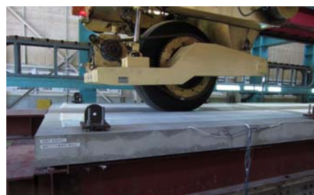
写真-2 ゴムタイヤ式輪荷重走行試験機
