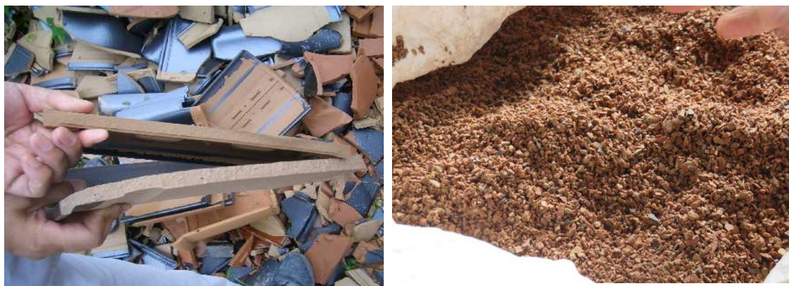
写真-1 廃瓦 (左) 廃瓦細骨材 (右)
