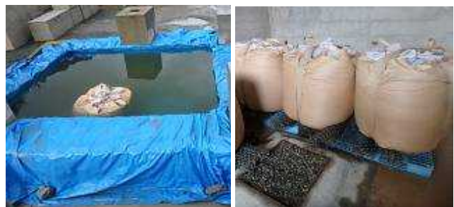
写真-2 廃瓦骨材吸水状況 (左) 水切り状況 (右)
