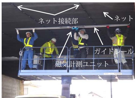
(2) 高所作業車デッキ上での B 橋の磁束密度測定
