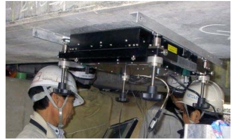
写真-4 光学的非接触全視野計測状況
