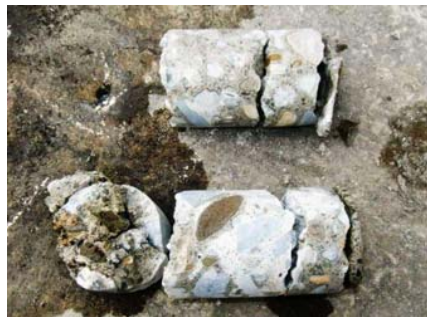
写真-3 床版および採取コアに生じた水平方向ひび割れ
