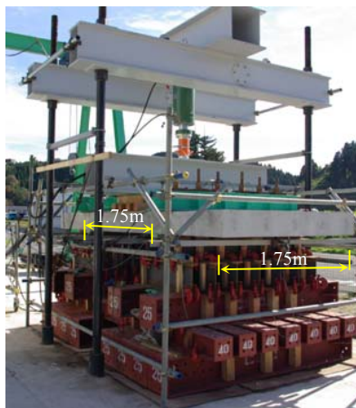
写真-6 押し抜きせん断載荷試験状況
