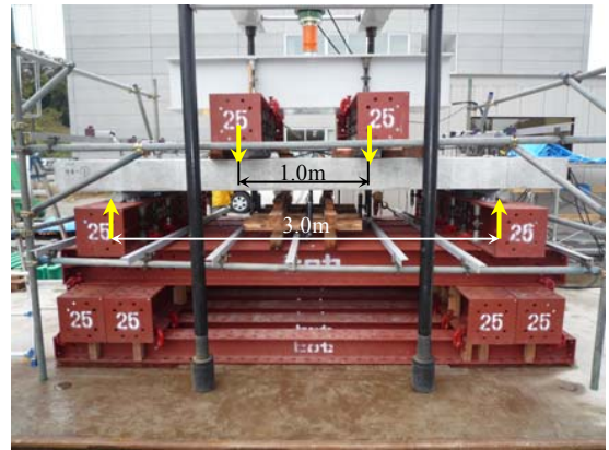
写真-5 曲げ載荷試験状況
