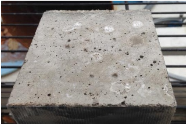
写真-1 KA28 試験体の塗布後の表面の状況
