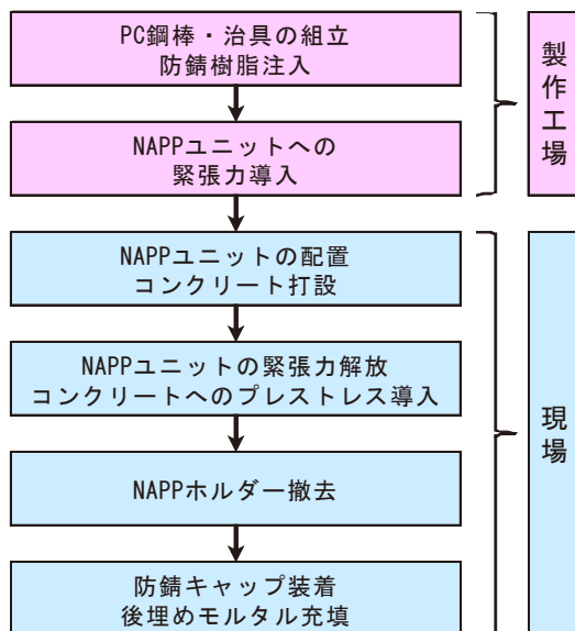
図-7 NAPP工法施工手順
