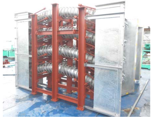
写真-4 主塔サドル
