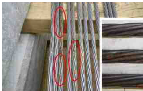
写真-4 未防錆 PC 鋼材 (PN-5)
