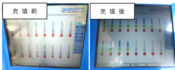
写真-1 充填確認機器
