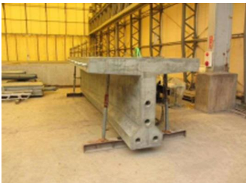
写真-1 脱枠後の状況
