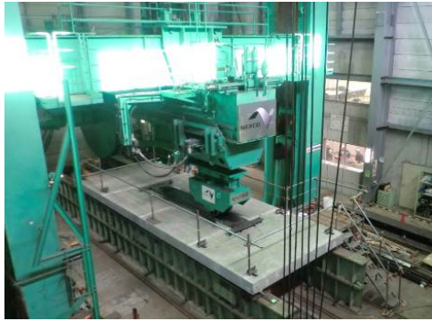
写真-1 輪荷重走行試験状況
