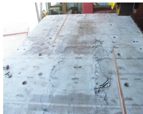
図-3 床版試験体破壊状況
