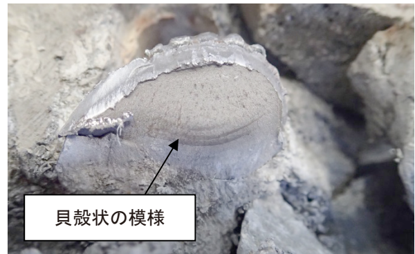
写真-8 スタッドの破断面(試験体No. 10)
