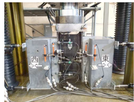
写真-4 押抜きせん断試験
