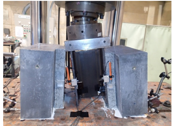
写真-6 試験体の破壊状況(試験体No. 8)
