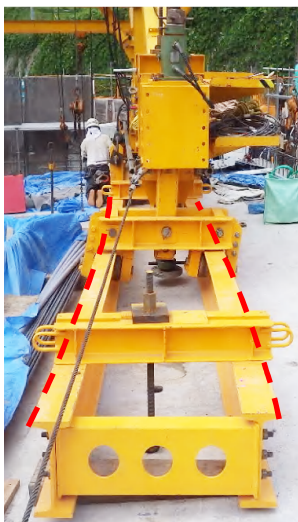
写真-3 曲がりレール
