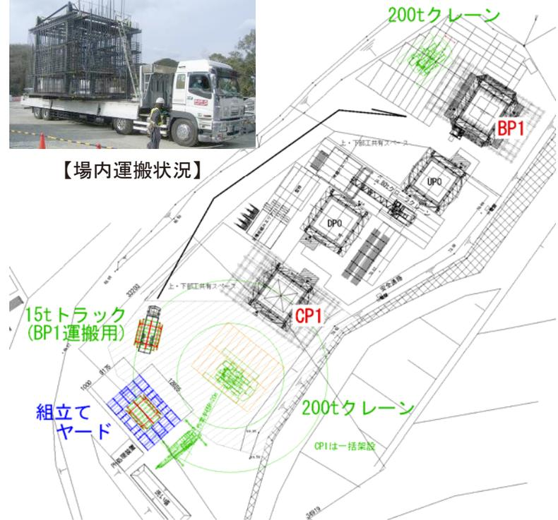
図-5 プレファブ鉄筋組立て作業ヤード図
