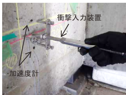
写真-2 衝撃入力装置
