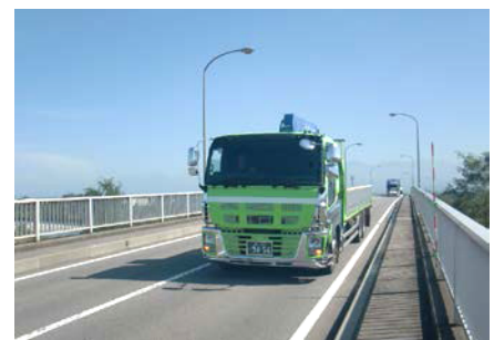
写真-5 走行載荷試験状況
