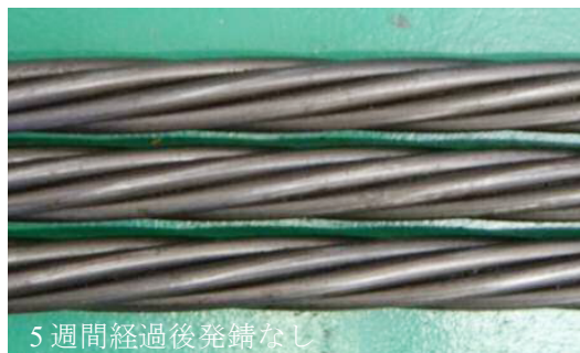
写真-1 一次防錆処理鋼材
