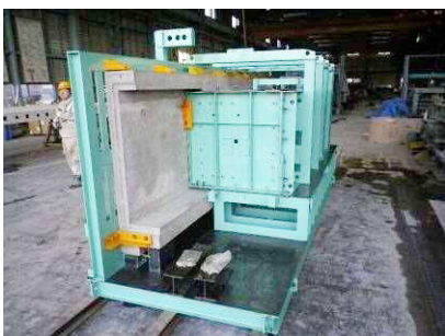
写真-9 PCF版打ち込み型枠
