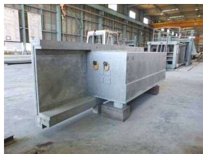
写真-10 PCF版打ち込み柱
