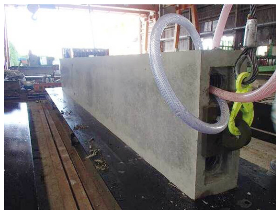
写真-5 ロータリースペーザー使用した部材
