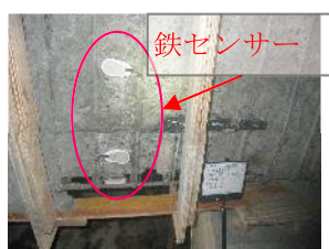
写真-6 腐食環境検知システム
