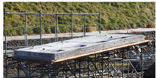
写真-3 上床版モデル試験体
