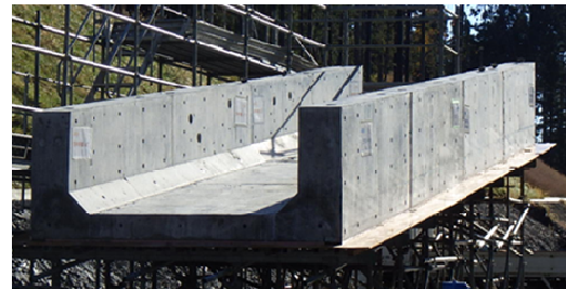
写真-1 下床版・ウェブモデル試験体
