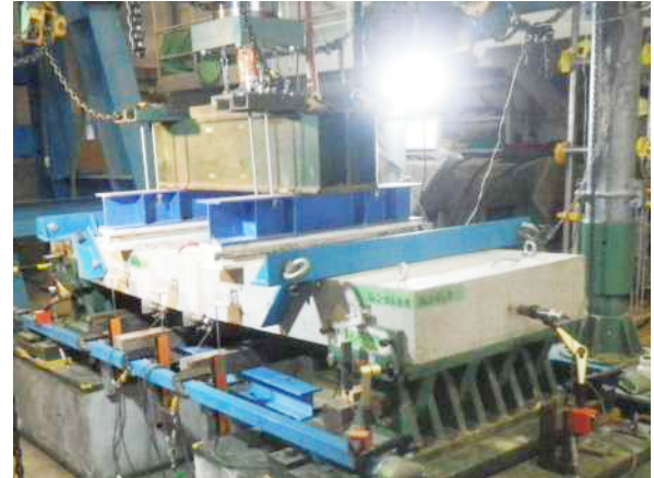
写真-5 静的曲げ荷重試験の状況
