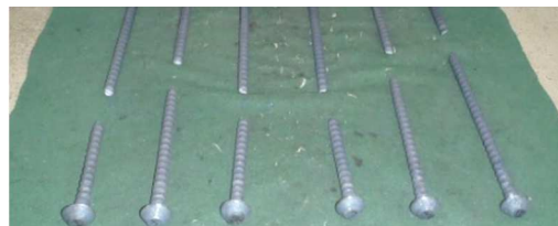
写真-2 引張試験破断状況
