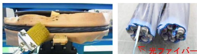
写真-1 エポキシ被覆型光ファイバー組込み式PC鋼より線の品質確認試験状況
