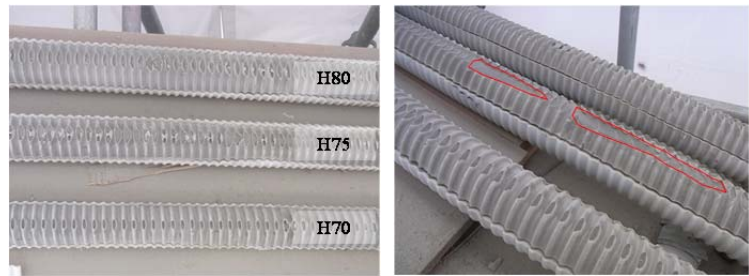
写真-3 高粘性タイプ (15°) のグラウト充填状況
