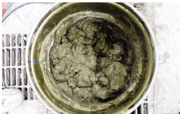
写真-3 一次練混ぜ後のPCグラウト
