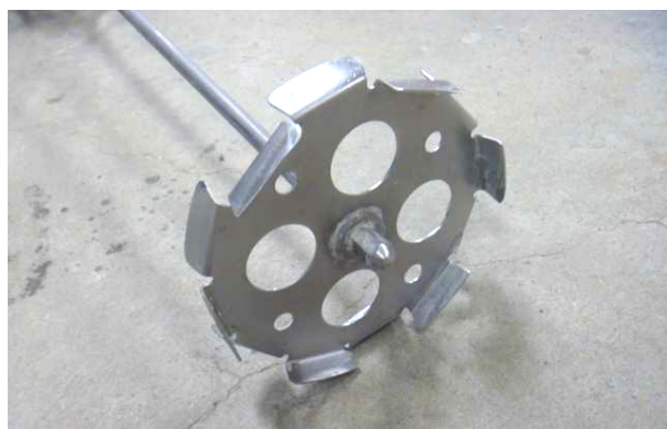
写真-1 ミキサーの羽(従来ミキサー(二次練り用))
