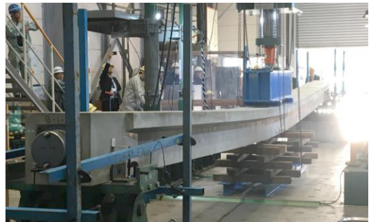
写真-1 曲げ載荷試験状況
