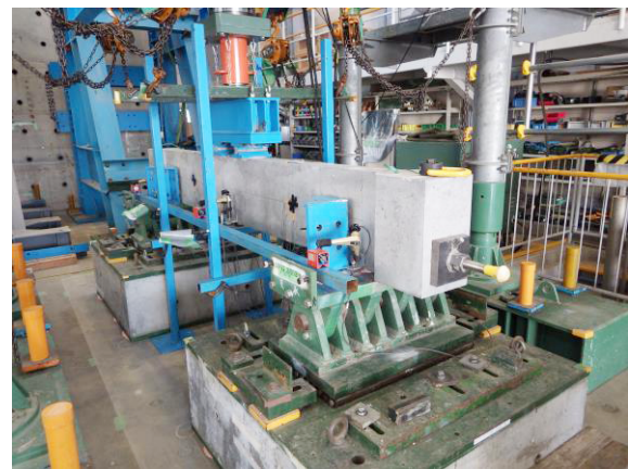
写真-2 せん断載荷試験状況
