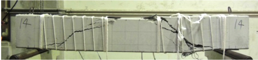
写真-1 破壊状況 (No. 14)
