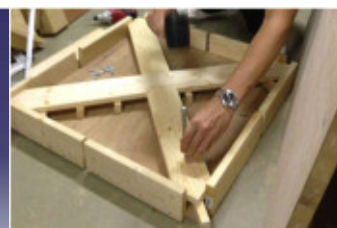
写真-10 加工精度をあげるためにガイド枠を用いる
