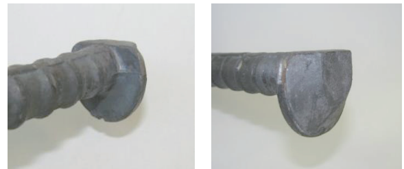
写真-1 Dエッジ鉄筋
