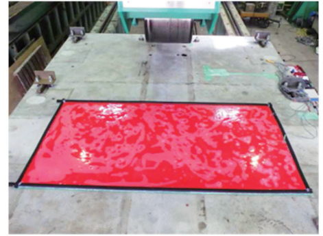
写真-5 漏水確認試験の状況
