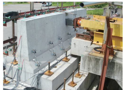
写真-1 台車を用いた衝突試験
