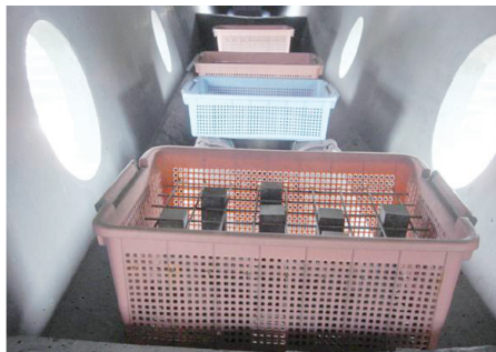
図-2 箱桁内の暴露供試体
