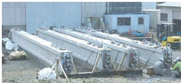
写真-2 実物大 PC 桁試験体
